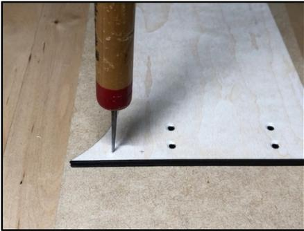
④まずは上板のみにヒンジを取り付け、下板のマークに拘らずに穴の中心位置にキリで下穴を空けて木ネジで取り付けます。
