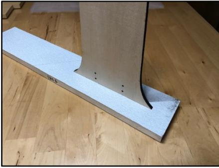
②上板の3mm穴（6か所）を皿モミ加工（表側）します
