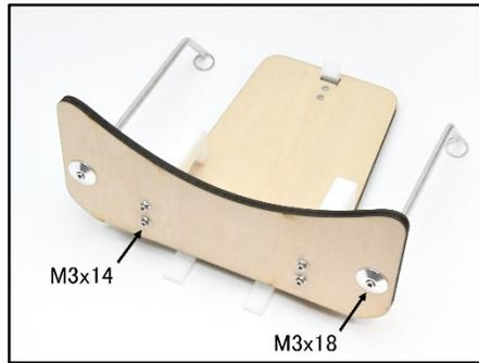
⑧一旦すべてのパーツを取り外し、各孔に低粘度瞬間接着剤を少量垂らし固めます。再度パーツを装着し完成です。
