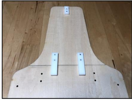
⑥写真の樹脂パーツ（左右有り注意）はM3x14キャップボルトと小ワッシャーで下側板に取り付けます。
