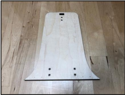
③上板のヒンジ取り付けマーク（十字）部にキリで下穴を空けます。木ネジの先端が噛む程度が良いです。
